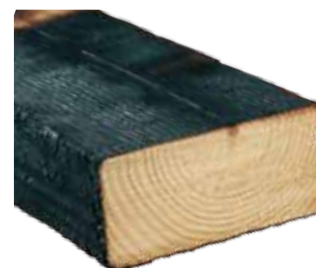
Sección de una madera tratada con PRO-FLAMEX SF, se observa como la combustión fue extinguida en el exterior sin causar daños a al interior de la madera. Eventualmente re-aplicar PRO-FLAMEX SF una vez al año.
