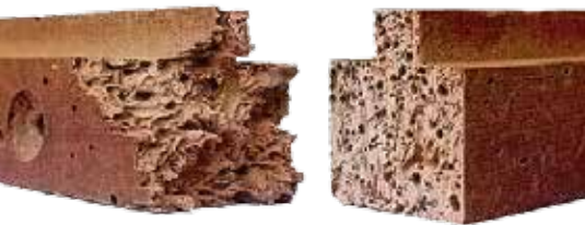
Daños ocasionados a la madera por la infestación de termitas.
